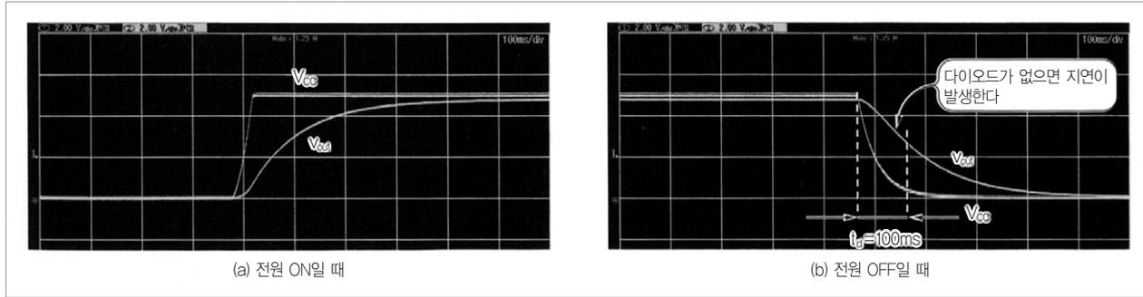
그림 34. 그림 33에서 전원 ON/OFF일 때의 각 부 파형 (2V/div, 100ms/div)
